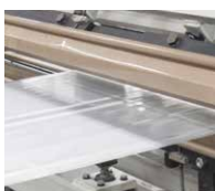
Im Flachfolienextruder hergestellte Folie.
